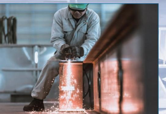
設計図面を基に製作を行います。作業工程は 材料発注・切断・溶接・孔明・防食・組立・完成 となります。完成した製品は厳密に検査を行い、 合格した後に現場へ出荷します。
