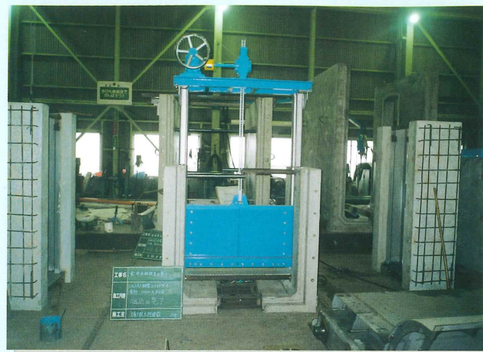
(ユニット式スライドゲート)
