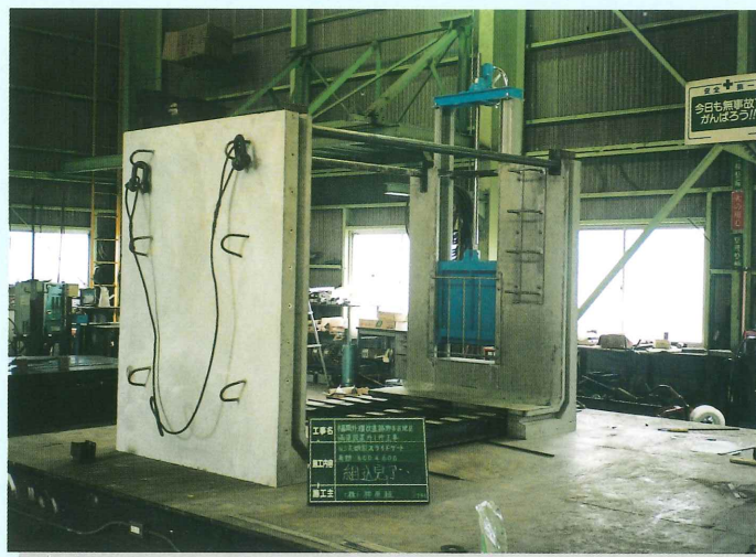
(ユニット式スライドゲート)
